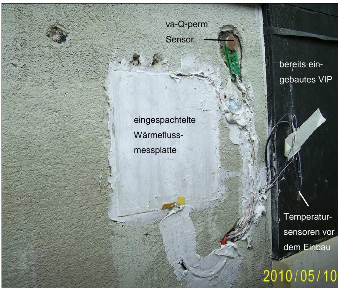
**Abbildung 18: Integration einer Warmeflussmessplatte, eines Temperatursensors sowie eines va-Q-perm<sup></sup> Sensors in die Auenseite einer Auenwand. Das VIP wird dann, wie am rechten Bildrand zu erkennen, von Auen auf dieser Anordnung angebracht (Bild: Hochschule Zittau/Gorlitz).**
